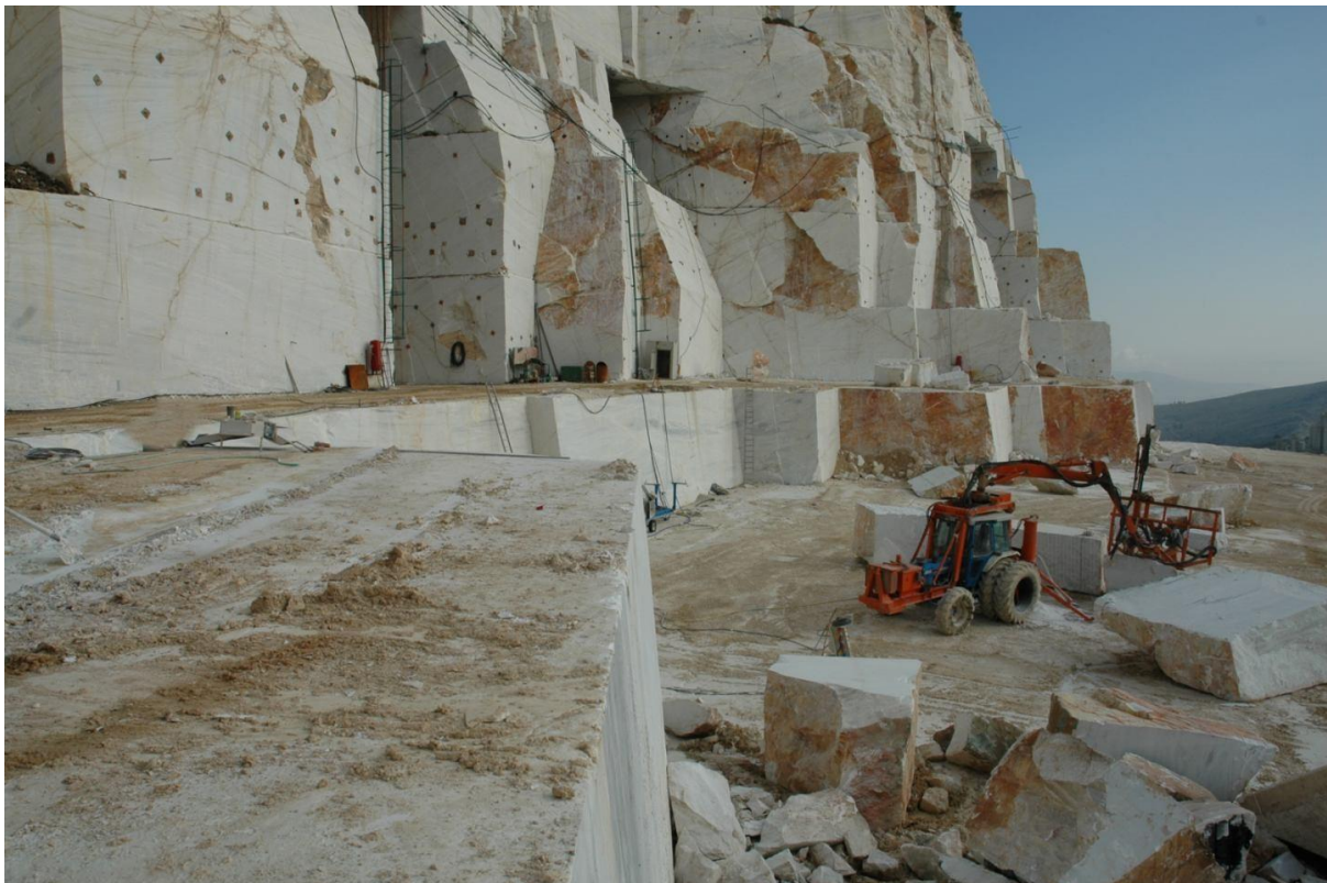
Μέτωπο εξόρυξης όγκων μαρμάρου από λατομείο της εταιρείας Dionyssomarble.
